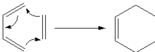
Figuur 5.48 Schematisch voorbeeld van de Diels-Alderreactie: reactie van buta-1,3-dieen en etheen geeft cyclohexeen.
