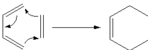
Figuur 5.51 Schematisch voorbeeld van de Diels-Alderreactie: reactie van buta-1,3-dieen en etheen geeft cyclohexeen.
