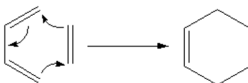
Figuur 5.53 Schematisch voorbeeld van de Diels-Alderreactie: reactie van buta-1,3-dien en etheen geeft cyclohexeen.
